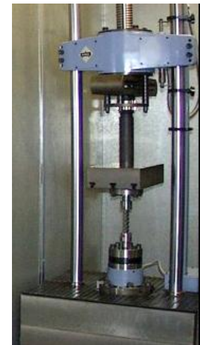
Test der dynamischen Belastbarkeit im Pulsator, Schwingfrequenz 50-100Hz
